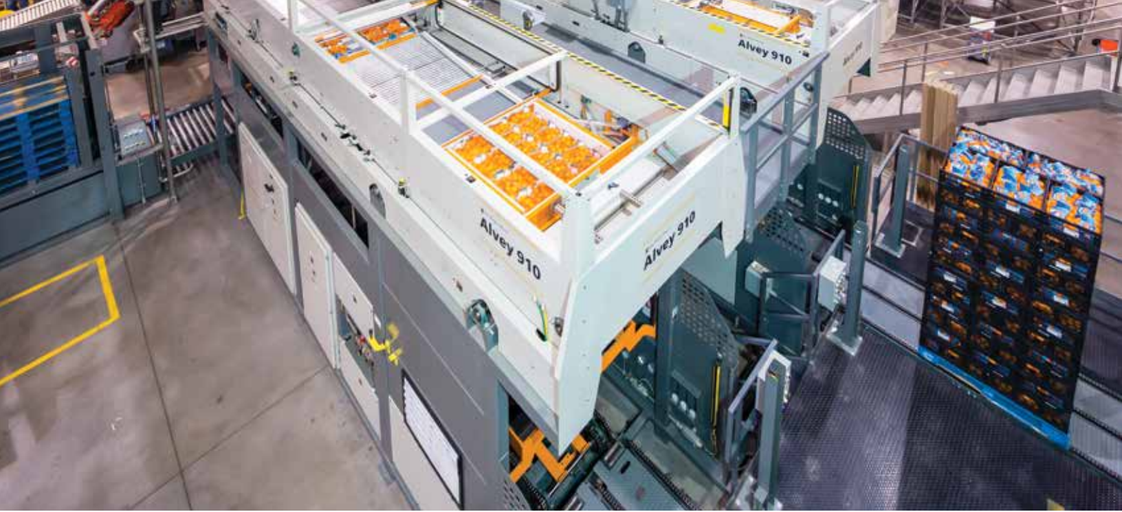
Les palettiseurs Alvey MD 910 empilent les caisses emboîtables selon le type d'emballage.
